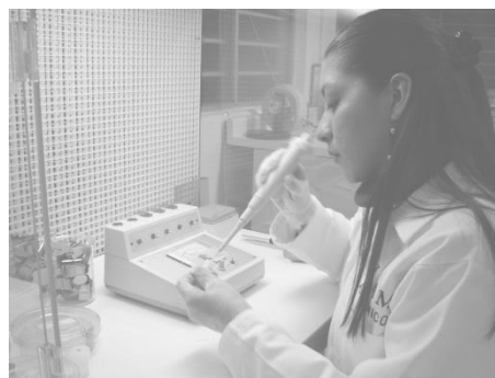
Figura 74. Carga de la muestra en los filamento de Re.
