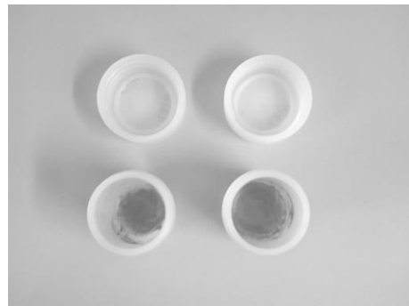
Figura 82. Evaporación de las muestras después de la digestión en la parrilla de calentamiento.
