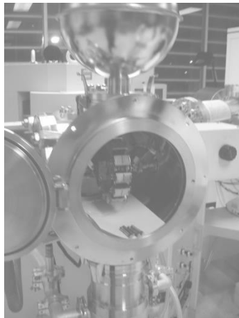
Figura 77. Fuente iónica abierta para el montaje del magazine.
