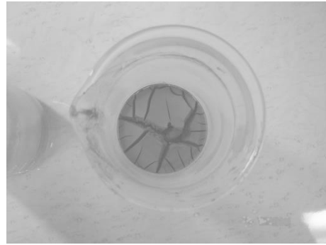
Figura 81. Obtención de pastillas de suelo parcialmente solidificadas.
