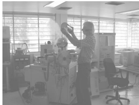
Figura 78. Colocación del Nitrógeno líquido para mejorar el vacío en la fuente iónica.
