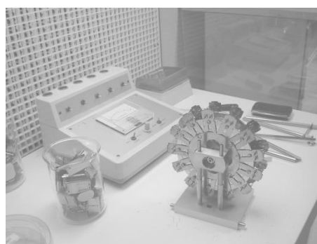
Figura 76. Magazín cargado con 26 filamentos de Re.
