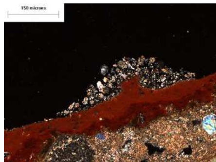
Ilustración 107: Muestra 6, misma área que la anterior pero con Nícoles cruzados y luz reflejada. Se observa que los cristales son de calcita y/o dolmita.. Fotografía: Luisa Straulino
