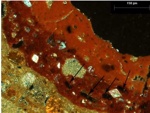
Ilustración 55: Hematita especular. Luz reflejada y Nícoles cruzados. Fotografía: Luisa Straulino.
