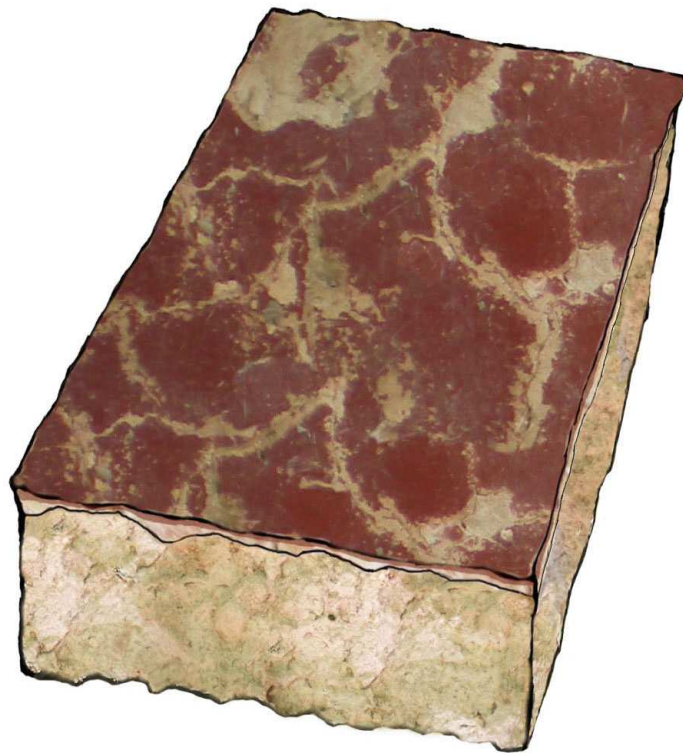
Ilustración 106: Tipo 4. De abajo a arriba: Repellado grueso blanco, con enlucido blanco y pigmento aplicado al fresco
