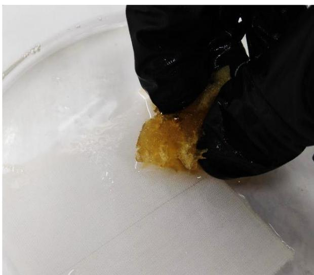
*Figura 19. Detalle de acción mecánica ejercida sobre la superficie de las probetas con una esponja marina.*
