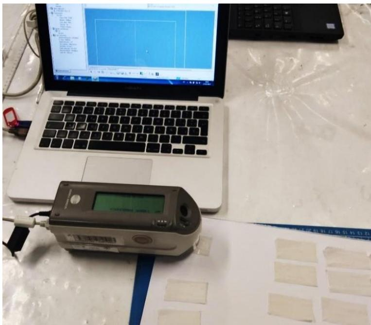
*Figura 27. Medición de colorimetría en probetas textiles en el Laboratorio CODICE-CNCPC.*
