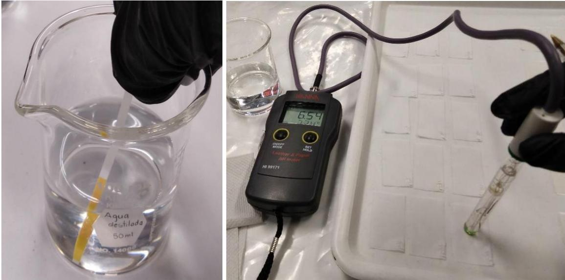
Figura 30. a. Medición de pH con tiras reactivas de surfactantes y agua destilada antes del lavado acuoso. b. Medición de pH de las probetas después del lavado con potenciómetro digital y electrodo de vidrio.
