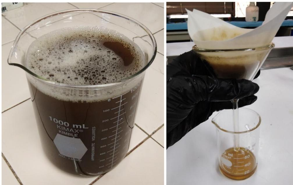
Figura 14. a. Disolución obtenida después de la primera filtración. b. Segunda filtración a través de papel filtro.
