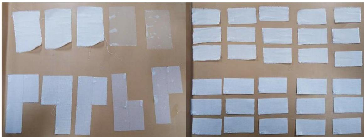
*Figura 21. a. Probetas extendidas sobre una superficie plana y limpia en proceso de secado. b. Las treinta probetas secas y separadas para la siguiente fase de la experimentación.*
