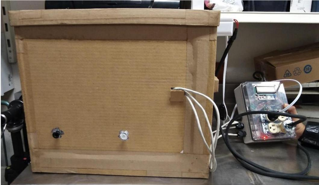
Figura 22. Cámara de envejecimiento y aparato de medición de condiciones ambientales. Los sensores se introducen por una apertura en la pared de la cámara.
