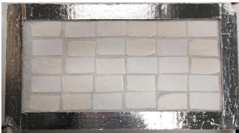
Figura 25. Distribución aleatoria de las probetas sobre el soporte de tela Reemay.
