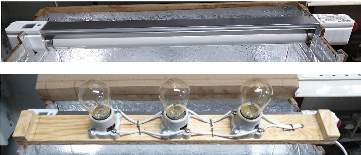
Figura 36. a. Lámpara de radiación UV. b. Lámparas incandescentes para radiación IR.
