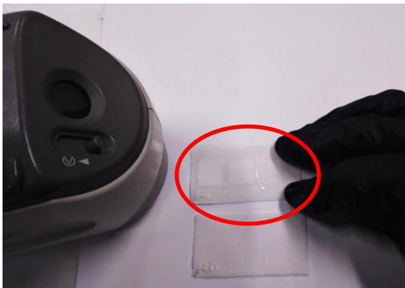
Figura 28. Acetato con tres orificios de 1 cm<sup>2</sup> colocado sobre una probeta (circulado en rojo).
