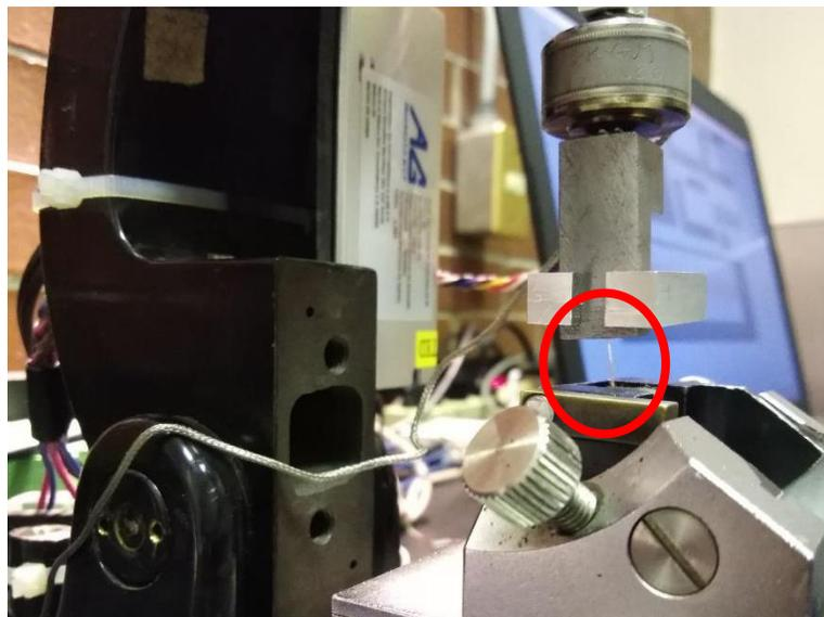
*Figura 32. Muestra de hilo (circulado en rojo) montada en la micro máquina de resistencia del LCMN-IF-UNAM.*
