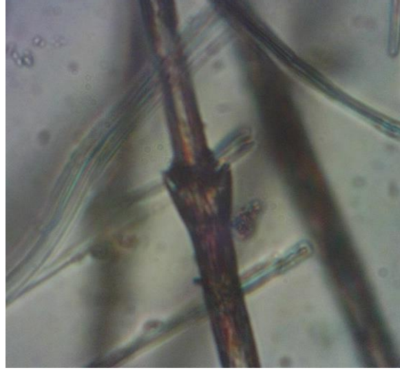
Imagen 40. Nodos de bárbula textil emplumado 40X.
