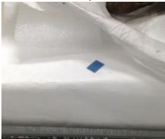
Imagen 139. Cinta reacciona a ácido acético. La tonalidad verde indica un pH de entre 4.8 – 5.5.
