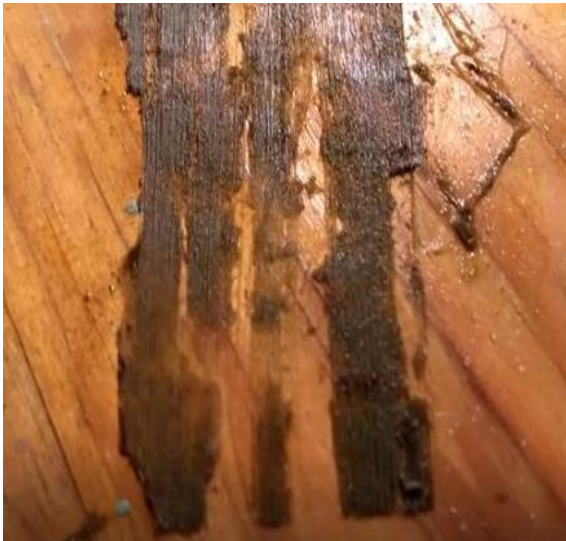
Imagen 98. Fibras rotas procedentes de la hoja que se sometió a un golpeado.
