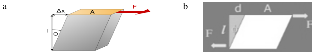
Figura 6.11. Cubo sometido a una fuerza cortante (a) diagrama del esfuerzo cortante (b), (Ambrose, 1998).
