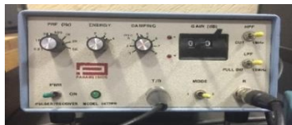
Figura 8.30. Pulsador/Receiver Modelo Panametrics (a) y Osciloscopio HP digital (b).
