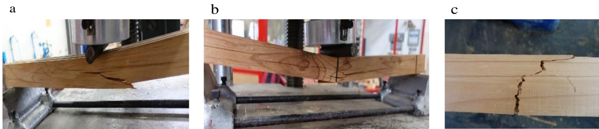
Figura 12. 21. Ensayos de flexión del Caso 3, falla de tensión simple (a), falla de tensión en sentido contrario de las fibras (b), falla de tensión astillada (c).
