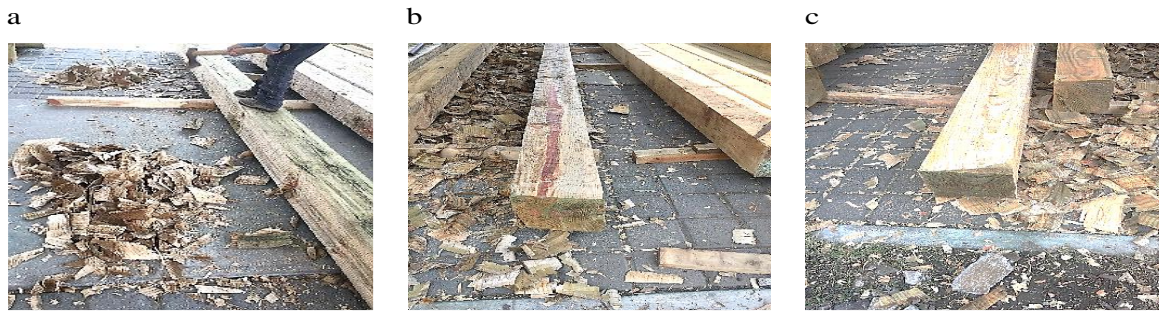
Figura 12. 10. Viguería de madera de reciente corta después del tratamiento de preservado en el proceso de espejeado (a, b y c).
