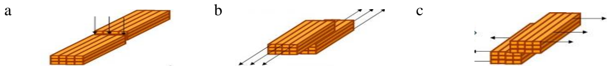
Figura. 6. 12. Tensión tangencial de cortadura, (a) tensión tangencial de deslizamiento (b) y tensiones tangenciales de rodadura, (c), (Giuliano, 2009).
