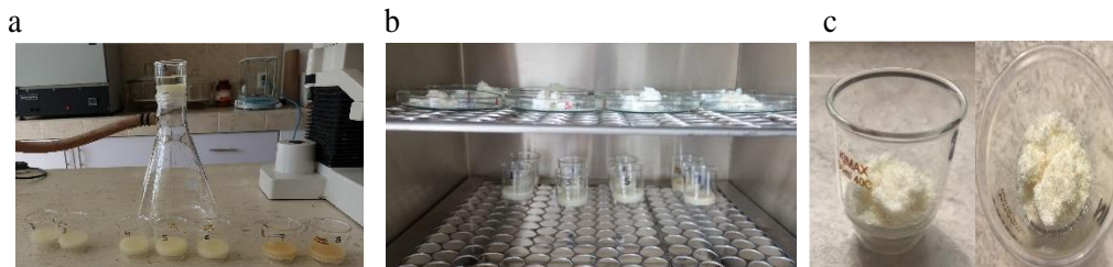
Figura 11.47. Filtros de vidrio para aplicar vacío (a), filtros en estufa de secado (b) y obtención de Holocelulosa (c).
