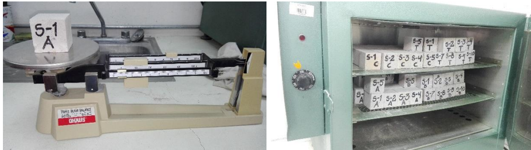
Fig. 41. Proceso del análisis del porcentaje de humedad actual. Fuente. Aldo Zamudio Pérez, 2017.
