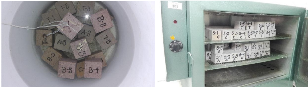
Fig. 42. Proceso del análisis de absorción de la ignimbrita. Fuente. Aldo Zamudio Pérez, 2017.
