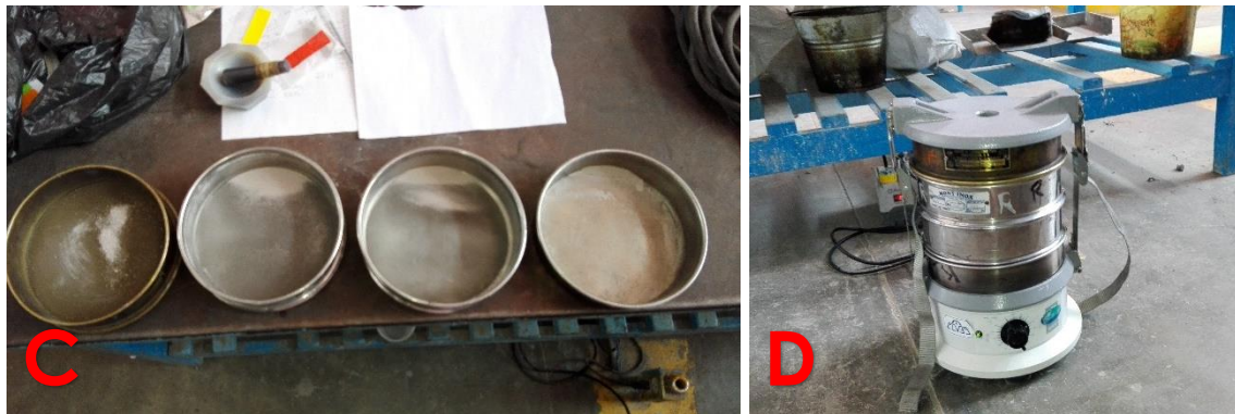
Fig. 54. Proceso de preparación de muestras para análisis de Rayos X en ignimbrita representativa del Pináculo del Centro Cultural de Clavijero. (C) Mallas para la criba del material pétreo molido (D) Tamiz vibratorio. Fuente Aldo Zamudio Pérez, 2017.
