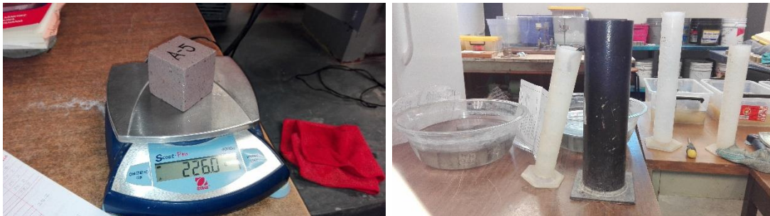
Fig. 38. Proceso del análisis de la densidad por medio del picnómetro. Fuente. Aldo Zamudio Pérez, 2017.
