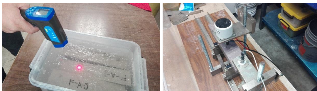
Fig. 46. Proceso del análisis del módulo de elasticidad de la ignimbrita. Fuente. Aldo Zamudio Pérez, 2017.
