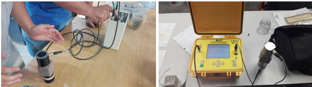
Fig. 44. Proceso del análisis de velocidad de pulso de la ignimbrita. Fuente. Aldo Zamudio Pérez, 2017.
