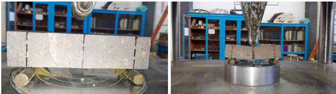
Fig. 48. Proceso del análisis de flexión de la ignimbrita. Fuente. Aldo Zamudio Pérez, 2017.
