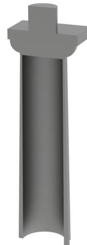
Fig. 76 Corte de la columna, se observa que la parte superior es una pieza maciza y el resto de la columna es hueca
