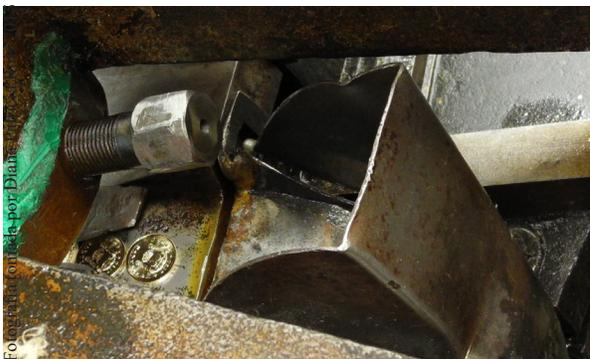
Fig.67 Conducto de salida de cospel
