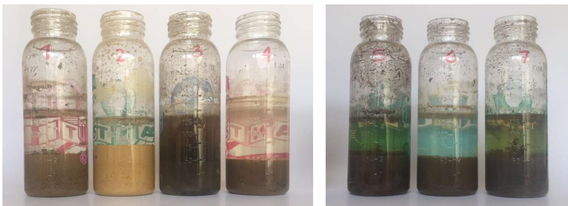
Ilustración 23. Pruebas de sedimentación de muestras de adobe tomadas en 1. Tinjacá (vereda Siativa); 2. Gachantivá; 3. Tinjacá (vereda Providencia); 4. Ráquira; 5. Villa de Leyva; 6. Sáchica y 7. Arcabuco. En todas ellas es notoria la baja proporción de arcillas con respecto a la de limos y arenas. Nótese las variaciones en la tonalidad de las tierras de acuerdo con cada municipio.
