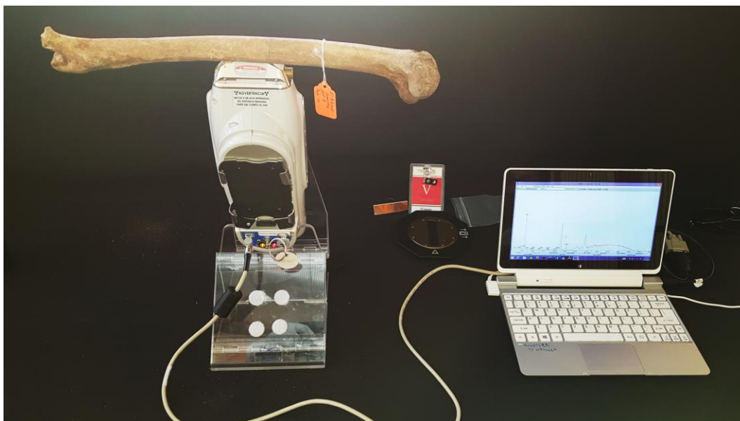
Figura 29 Proceso de análisis mediante XRF a restos humanos prehispánicos. Foto: Israel Lara/INAH 2019.
