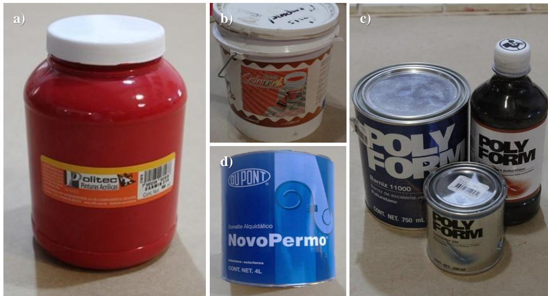
Figura 17. Recubrimientos utilizados en la elaboración de los sistemas probeta, a ) Pintura acrílica de la marca Politec® (CP), b ) resina acrílica (CC), c ) Barniz de poliuretano (BP), y d ) Esmalte alquidílico (EA)
