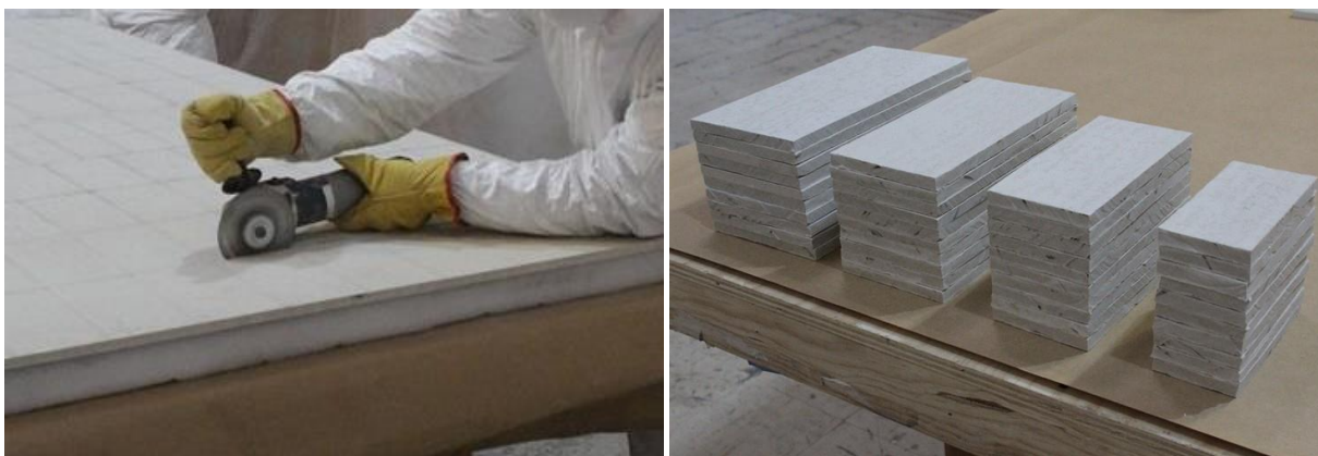
Figura 20. Proceso de corte del panel de fibrocemento para los soportes de los sistemas probeta
