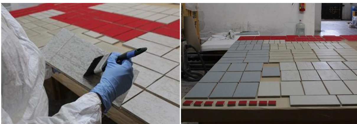
Figura 22. Aplicación de recubrimientos por el reverso del soporte de FC
