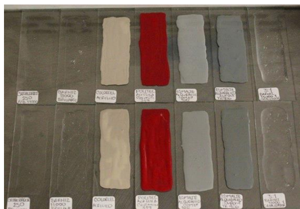
Figura 27. Recubrimientos aplicados sobre portaobjetos para la medición FTIR
