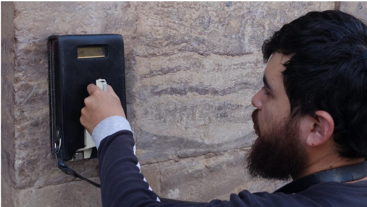
Figura 4. Ejemplo de medición de rayos gamma con un espectrómetro portátil en la Casa de cantera.
