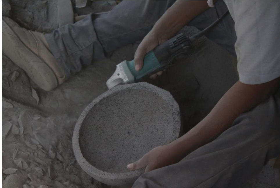
Figura 62 Con la pulidora chica se le da acabado a la cazuela, el cuerpo y las patas.
