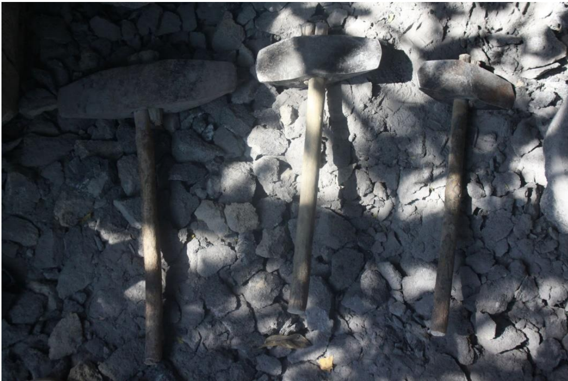
Figura 48 Los distintos fierros que se utilizan en la manufactura de los metates y molcajetes.
