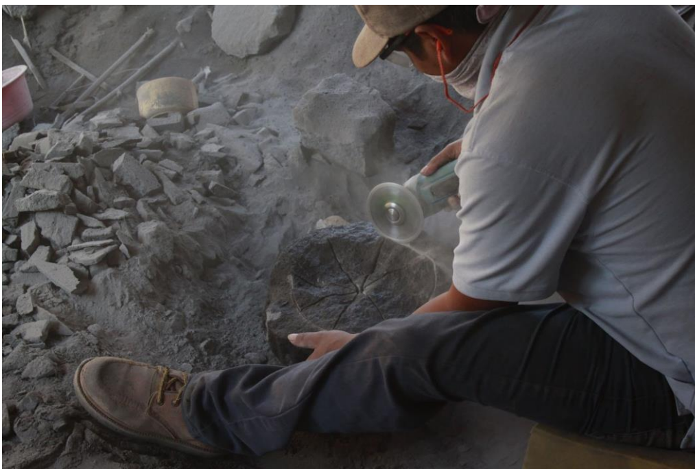
Figura 58 El maestro artesano Ramiro ranurando una preforma con la pulidora y cubriendo boca y nariz con un paliacate para evitar que entre demasiado polvo.
