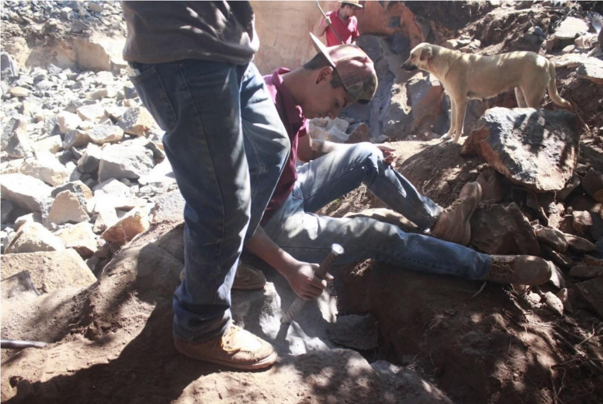
Figura 54 El barreno es un agujero profundo en la piedra para colocar la pólvora y la tierra.
